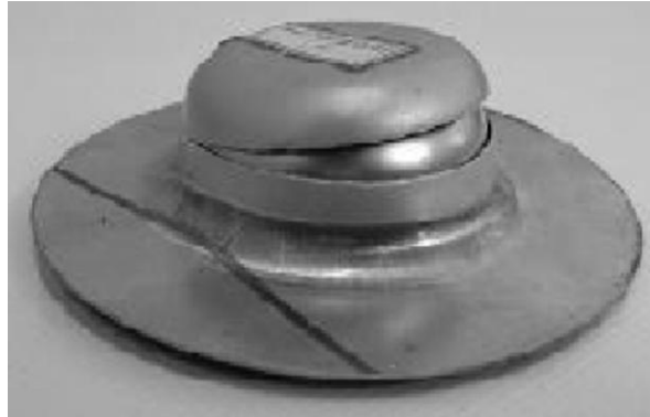
Gambar 3.0 Contoh Tearing Atau Cracking pada Material
