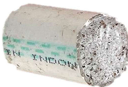
Gambar 2. Pipa PVC + Mortar Ringan
