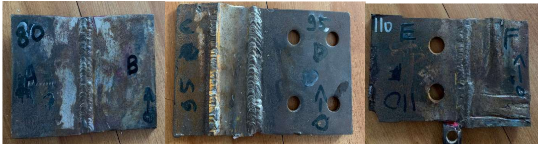
Spesimen 80A 1a,1b Spesimen 95A 2a,2b Spesimen 110A 3a,3b Gambar 3: Hasil Uji spesimen pengelasan dengan variasi arus 80 Ampere, 95 Ampere, 110 Ampere.
